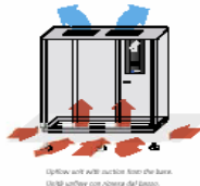
Upflow unit with discharge from the base. Uniti Upflow con espone dal basso.
